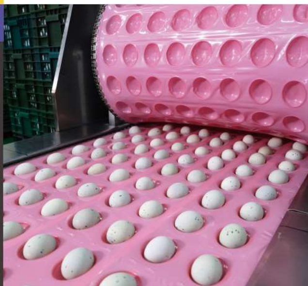
SBIR 計畫挹注的「上下雙面拉伸膜全自動真空包裝機」，大幅改善過去因為乳凸點所導致的漏氣問題。
