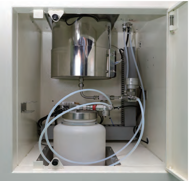
以純甲酸取代傳統助焊劑，結合 UV 光解 VOC 淨化系統與智慧型供酸控制，實現零污染製程，達成節能減碳 30% 的 ESG 目標。
