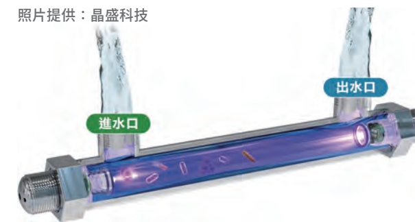
高聚光 UV-C LED 淨水模組，整合光學透鏡、流體導向與智能控制系統，在限制管道中實現「光速滅菌」，相較傳統 UV 水銀燈管，可節省六成能耗。
