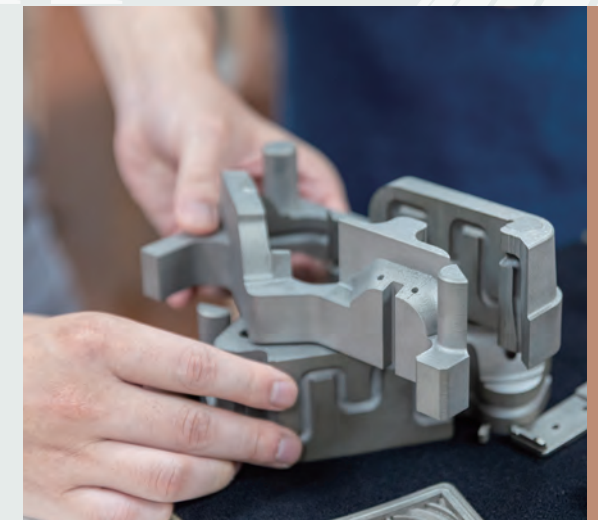
依模具用途設計隨形水路，有效提升模具冷卻與製造效率。
