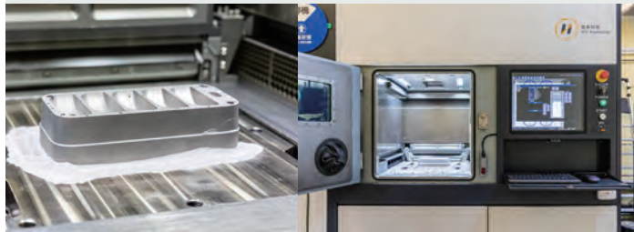
金屬 3D 列印的「加法」製模可大幅減少開模產生的廢料。
