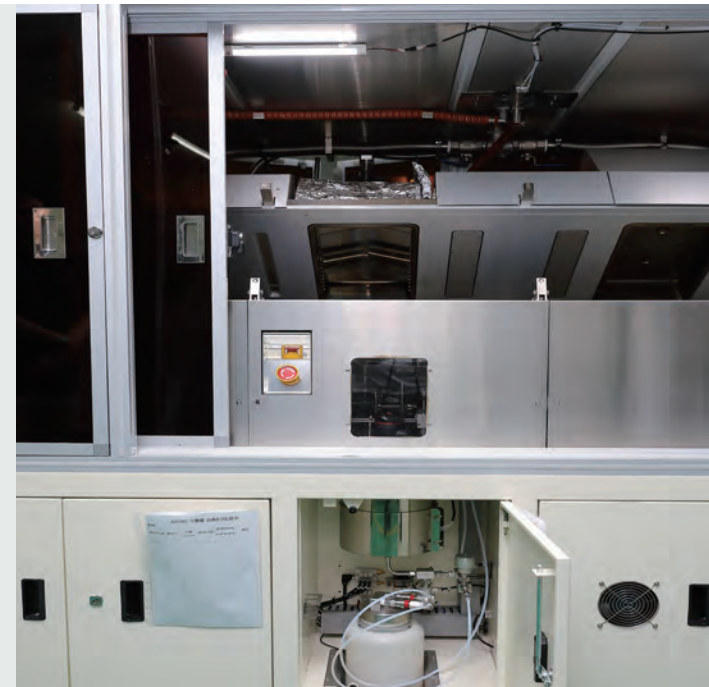
以純甲酸取代傳統助焊劑，結合 UV 光解 VOC 淨化系統與智慧型供酸控制，實現零污染製程，達成節能減碳 30% 的 ESG 目標。
