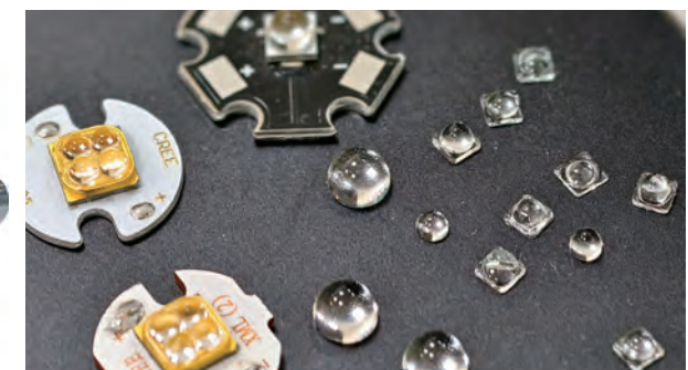
高聚光 UV-C LED 淨水模組，整合光學透鏡、流體導向與智能控制系統，在限制管道中實現「光速滅菌」，相較傳統 UV 水銀燈管，可節省六成能耗。
