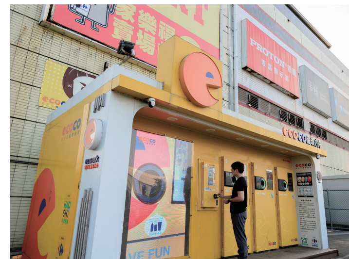
寶特瓶、鋁罐、電池等回收物分別設置專屬投入孔，清楚分流。
