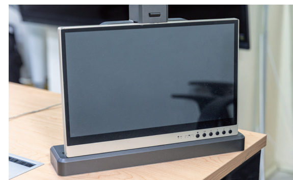
無線螢幕沒有作業系統、記憶體，打開便能自動連線遠端主機 IP，抓取使用者桌面。
